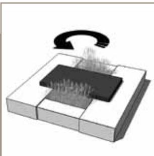
Mit dem DHF - System (Mechanik aus Edelstahl) lässt sich die Abdeckplatte durch Drücken und Drehen öffnen bzw. schließen und versenken. Der Hinterbliebene kann, solange er es möchte, die
