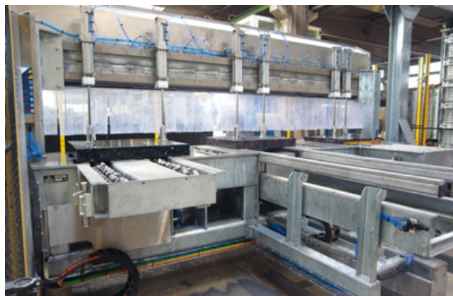
Die Werkstücke werden automatisch platziert und fixiert.
